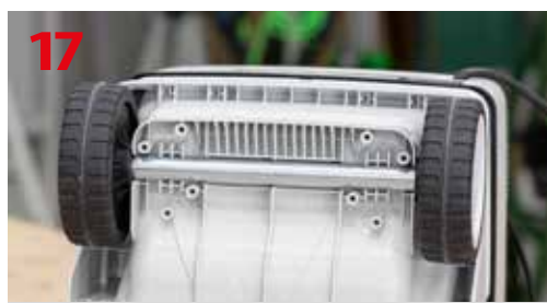
Stalowa, bardzo solidnie wykonana oś dużych kółek odkurzacza Festool CT 15 E
