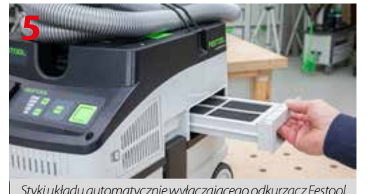
Styki układu automatycznie wyłączającego odkurzacz Festool CT 15 E w przypadku napełnienia zbiornika do maksymalnego bezpiecznego poziomu płynów/odpadów mokrych
