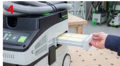
Montaż filtra do pracy na mokro w odkurzacz Festool CT 15 E
